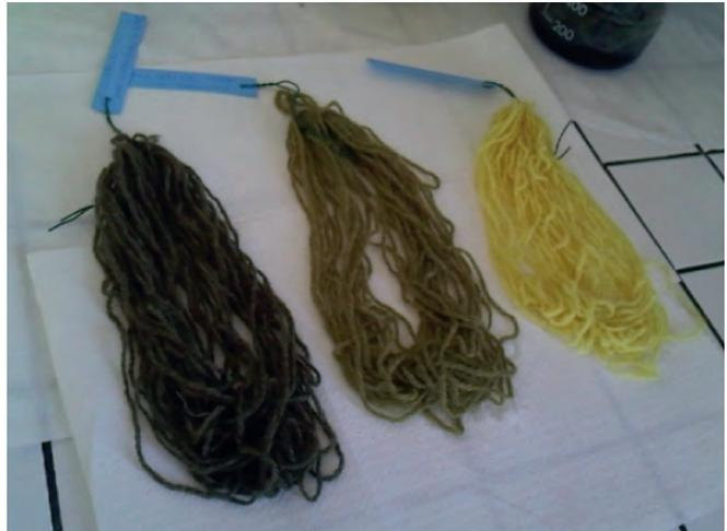
**Figura 23.** Matassa di lana in ammollo in acqua distillata prima della tintura (sinistra); matasse di lana colorate, lavate e lasciate asciugare su carta filtro in relazione alle tre diverse procedure di mordenzatura seguite (destra)
