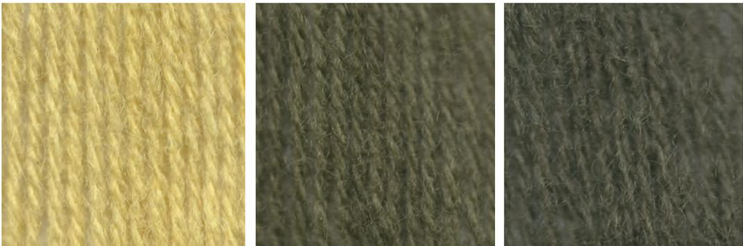
Figura 39. Colorazioni ottenute con foglie di *Ficus carica* L. con macerazione. Da sinistra: mordenzatura con allume, mordenzatura con viraggio di colore e mordenzatura contemporanea
