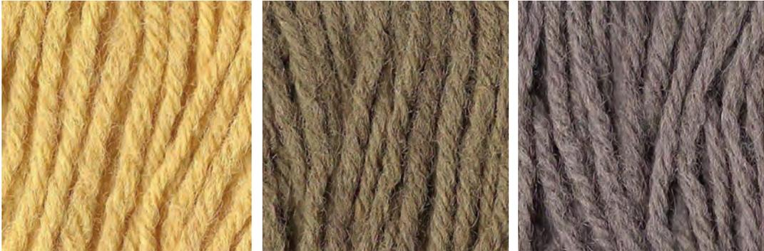
**Figura 51.** Colorazioni ottenute con foglie di *Pistacia lentiscus* L. con estrazione diretta. Da sinistra: mordenzatura con allume, mordenzatura con viraggio di colore e mordenzatura contemporanea
