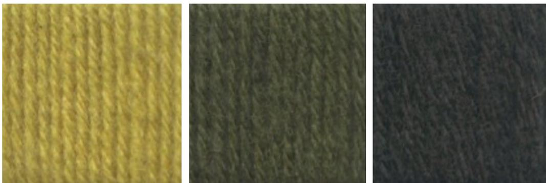
Figura 55. Colorazioni ottenute con pericarpo dei frutti di *Punica granatum* L. con estrazione diretta. Da sinistra: mordenzatura con allume, mordenzatura con viraggio di colore e mordenzatura contemporanea
