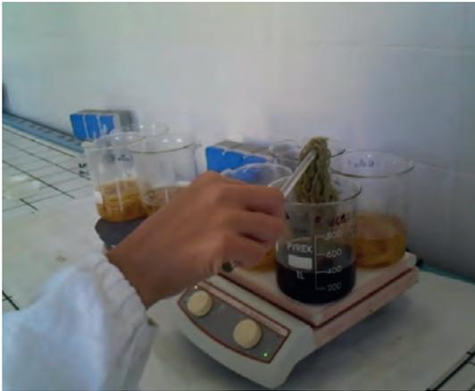
**Figura 22.** Metodi di tintura. In primo piano si nota la colorazione della tintura con “mordenzatura contemporanea”, dietro è visibile quella del processo di “pre-mordenzatura”
