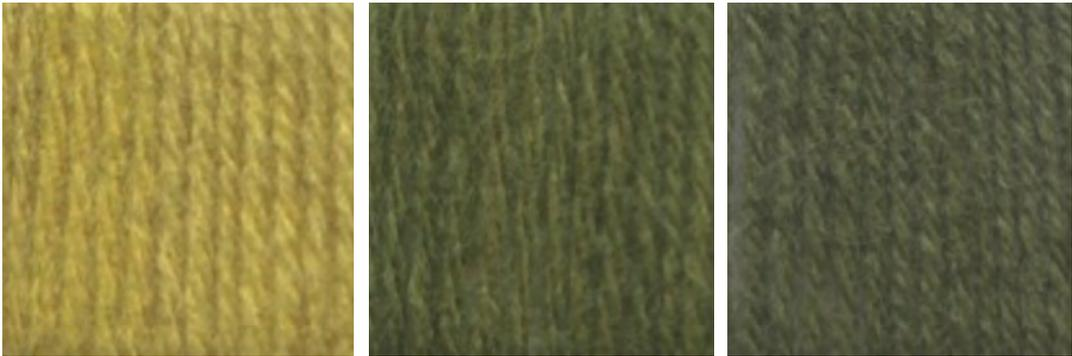
Figura 38. Colorazioni ottenute con foglie di *Ficus carica* L. con estrazione diretta. Da sinistra: mordenzatura con allume, mordenzatura con viraggio di colore e mordenzatura contemporanea
