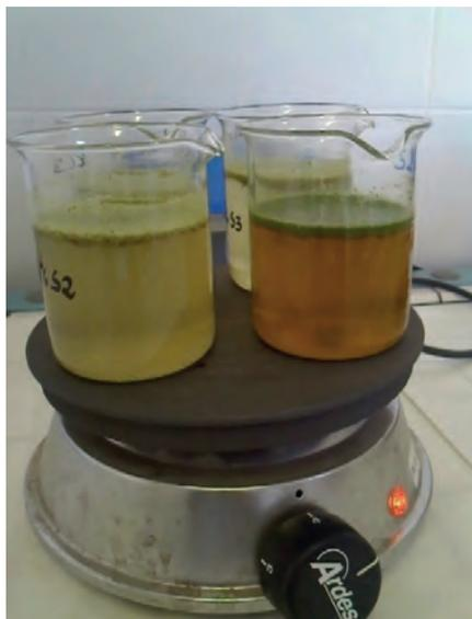
**Figura 21.** Materiale vegetale estratto mediante decozione su una piastra riscaldante
