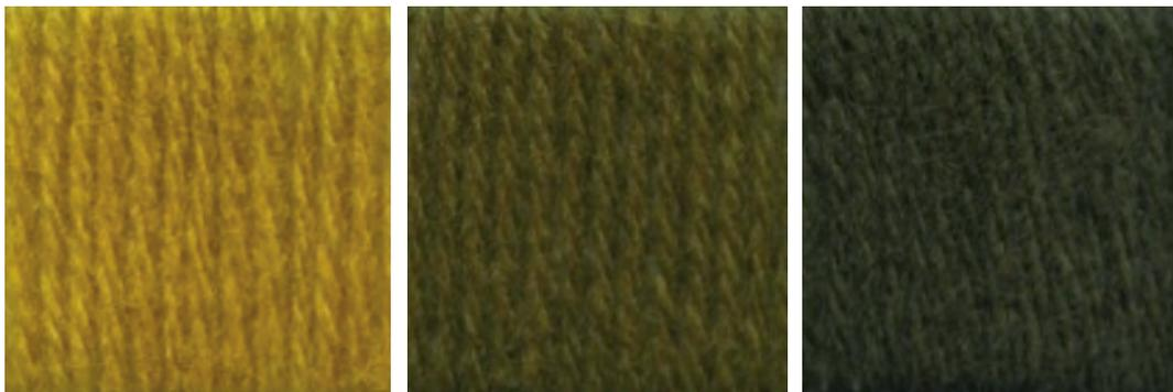
**Figura 71.** Colorazioni ottenute con infiorescenze di *Solidago canadensis* L. con estrazione diretta. Da sinistra: mordenzatura con allume, mordenzatura con viraggio di colore e mordenzatura contemporanea
