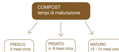
Figura 2. Schema relativo ai diversi tempi di maturazione a cui corrispondono compost dotati di caratteristiche differenti
