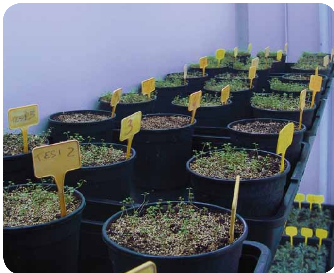
Test di germinazione in cella climatizzata relativo a miscele di compost e substrati di coltivazione per la coltivazione di specie aromatiche presso il Cersaa di Albenga
