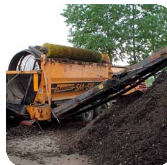
Vaglio per la lavorazione del compost
