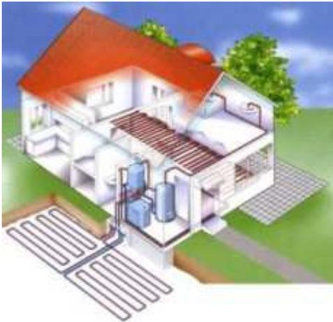
Figura 3-11: Sistemi geotermici a circuito chiuso di tipo orizzontale
