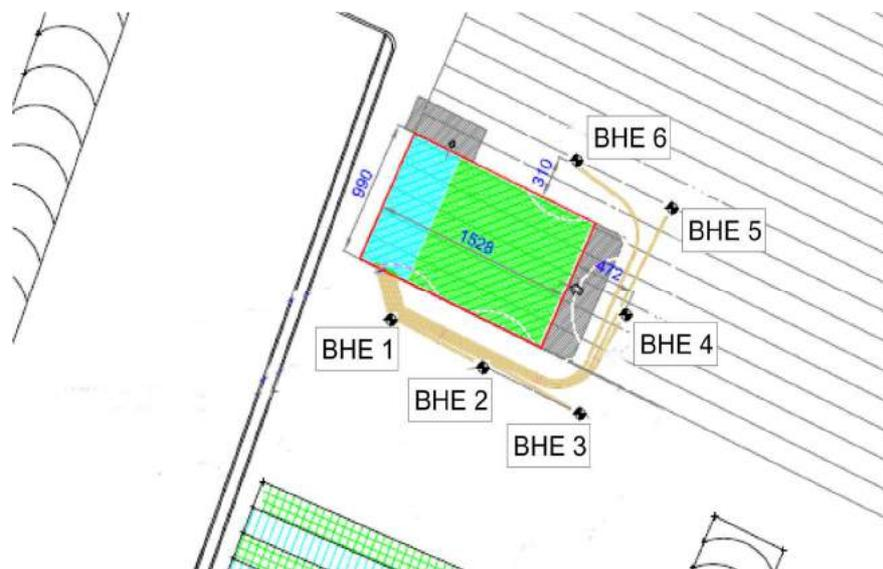
Figura 4-10: Pianta della serra e configurazione del campo sonde geotermiche
