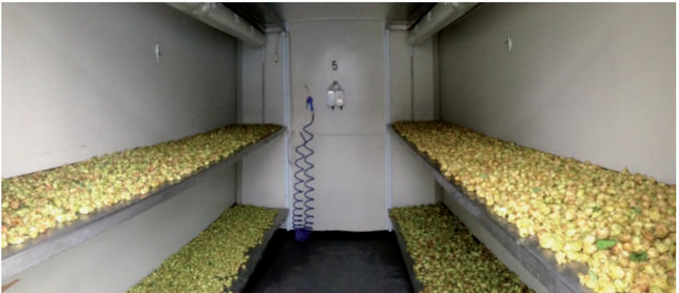
Il prodotto così essiccato è stato imbustato all'interno delle celle, posto sotto vuoto (< 5 cm di Hg) e raccolto all'interno di un congelatore (Temperatura: -20°C).
