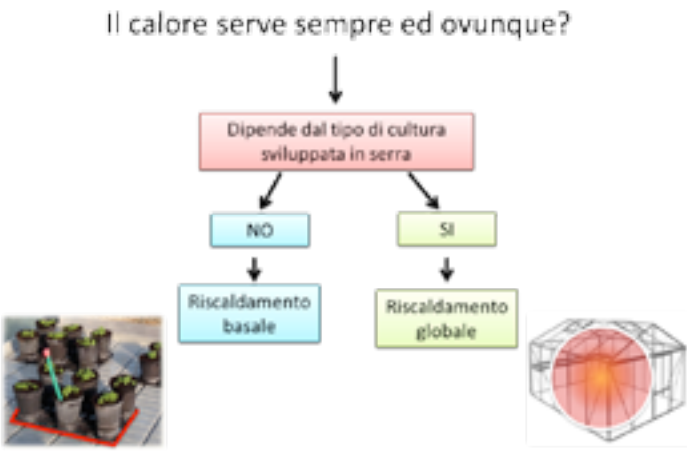
Figura 1. Semplice schema decisionale per definire il tipo di sistema di riscaldamento necessario.
