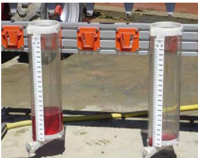
a sinistra: Misurazione della portata degli ugelli
