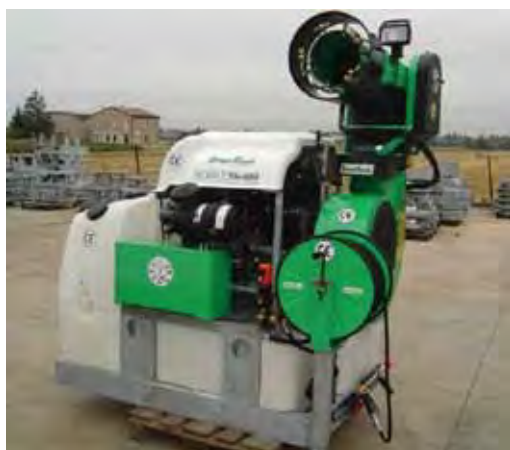
Atomizzatore portatile su pianale con cannone e lancia a mano
