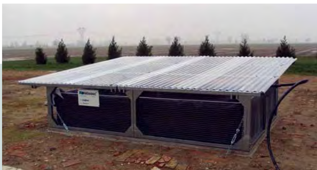
Sistema per la gestione dei reflui di prodotti fitosanitari. (Heliosec®)
