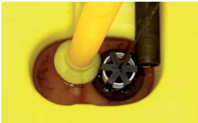
Pozzetto di prelievo della miscela all'interno dell'irroratrice
