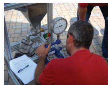
Fig 60 Controllo del manometro
