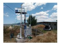
tecnologie innovative ed affidabili rivolte alla misurazione in loco delle emissioni di CO<sub>2</sub>, CH<sub>4</sub> e N<sub>2</sub>O, i cosiddetti gas serra. Tale misura è affidata a dispositivi innovativi che sfruttano la tecnologia <u>LIDAR</u> (in pratica un raggio laser) per la misurazione di gas serra su larga scala (fino a 10 km di distanza). I dispositivi saranno installati presso l'oliveto sperimentale del CeRSAA in Regione Rollo ad Albenga e presso il porto di Andora.
